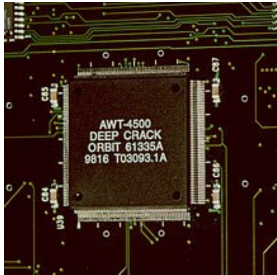
“Deep crack” DES cracker
