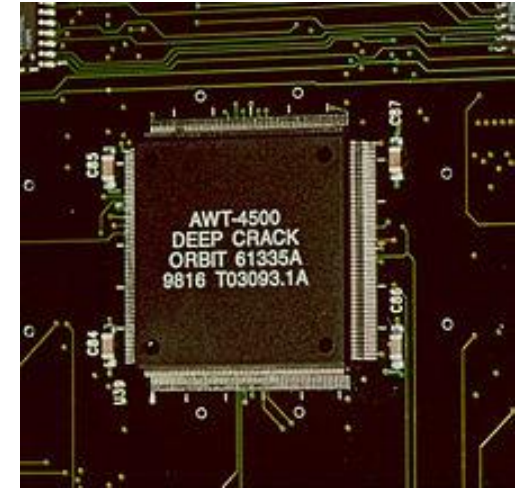
“Deep crack” DES cracker
